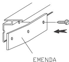
OBSERVANDO o desenho abaixo, sobre uma mesa ou bancada, monte todos os anéis de fechamento colocando o outro parafuso auto-atarrachante, observando o aperto cuidadoso. Você fechará o círculo dos anéis fora ainda fora das longarinas.
