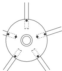
PASSEMOS agora para a montagem dos anéis de fechamento. Tome as emendas e prenda-as em uma das extremidades dos anéis como mostra a figura ao lado com um parafuso auto-atarrachante. Aperte bem, mas com cuidado.
