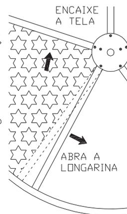
O REFLETOR Cromus possui um exclusivo grampo em forma de "J". Perfeito para a fixação da tela no anel de fechamento, basta observar o croqui ao lado para se obter o máximo de eficiência desta fixação.
