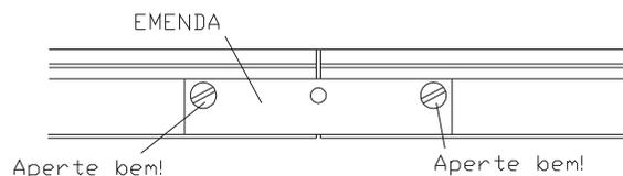
TOME o círculo de anéis de fechamento montados e posicione-os nas extremidades das longarinas já colocadas no corpo do cabeçote. Escolha as duas longarinas que possuem os dois parafusos no cabeçote, e "ponteie" os parafusos auto-atarrachantes neles. **NÃO Dê APERTO DEFINITIVO AINDA, APENAS APONTE O PARAFUSO NO OLHAL CRAVADO DA LONGARINA.**
