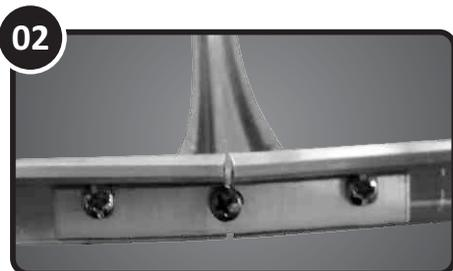
Na extremidade do fechamento utilize as chapas de emenda prendendo com o parafuso auto-tarrachante (Fig. 02). Apenas aponte o parafuso no olhal cavado na ponta da longarina (Fig. 03). O aperto definitivo deve ser feito apenas após o encaixe das telas.
